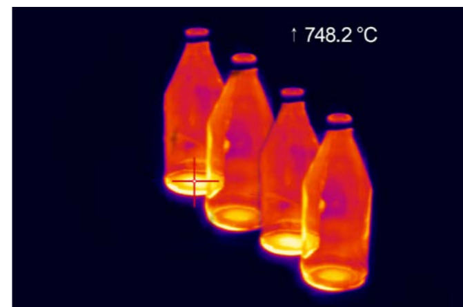
Mesure Hot Spot dans la fabrication de bouteilles en verre
