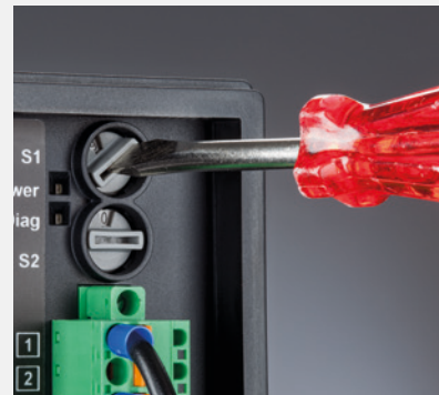
Plages d'entrée et sortie de signaux normalisés libre de potentiel commutables
